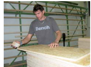
Die scharfen Kanten mussten geschliffen werden.
