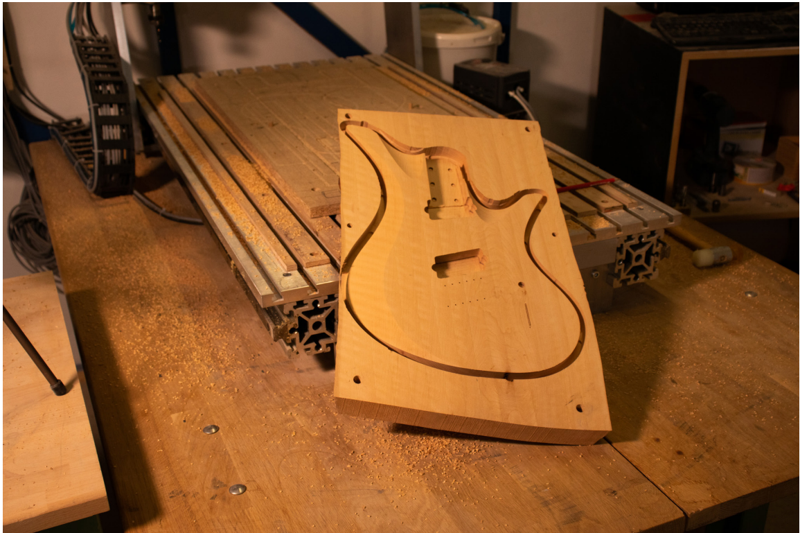
Abb. 4 Korpus nach dem Fräsen während „ON ISOLATION“.
