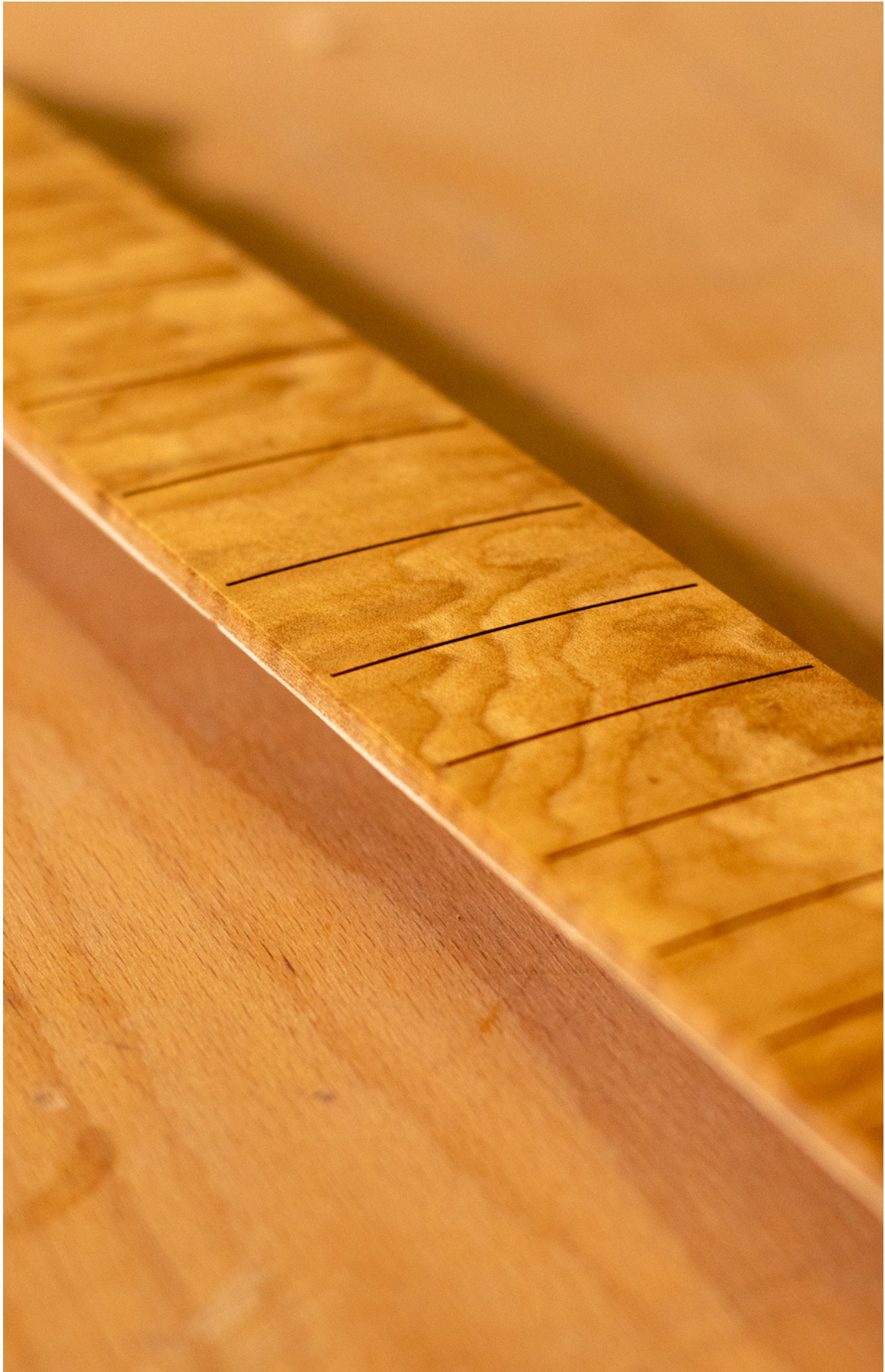
Abb. 5 Nahaufnahme von „sonowood“ verarbeitet zu einem Griffbrett.
